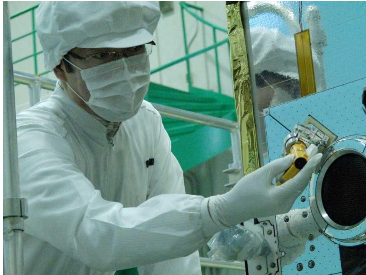
ガスが正しく流れ出ているかどうかの確認作業
