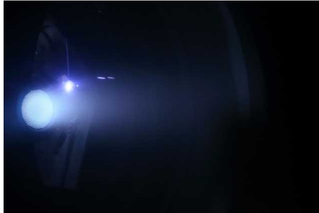
スラスタの模型(左) フライト用スラスタAの 運転中の様子(右)
