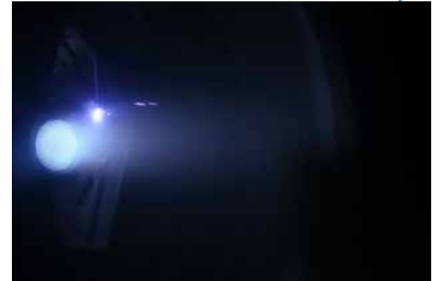
フライトモデルの真空チェンバ内での噴射試験の様子
